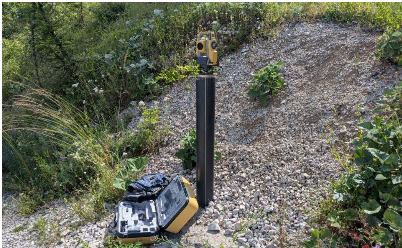
Foto 7 – Base di stazione fissa con posizionata stazione totale TopCon OS-105D
