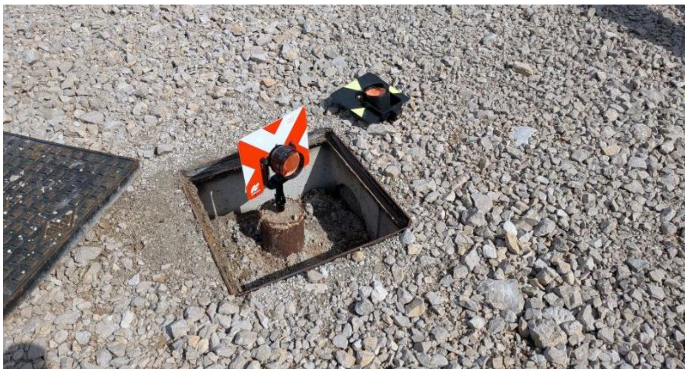
Foto 2 – Cippo C1 con posizionato prisma TopCon dotato di prolunga di 10 cm
