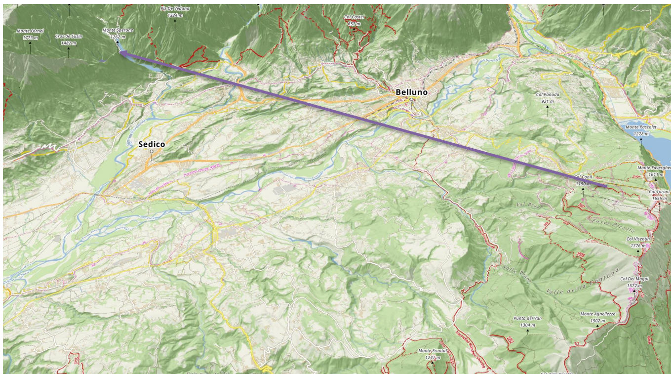
Figura 2 – Azzeramento del cerchio azimutale sulla croce del Monte Sperone
